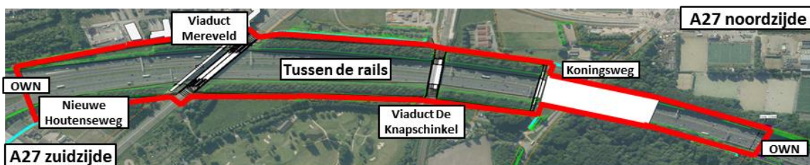
Afbeelding 4.1 Bovenaanzicht schermwand (rode contour) en ligging overkapping betonnen bak (witte vlak)
