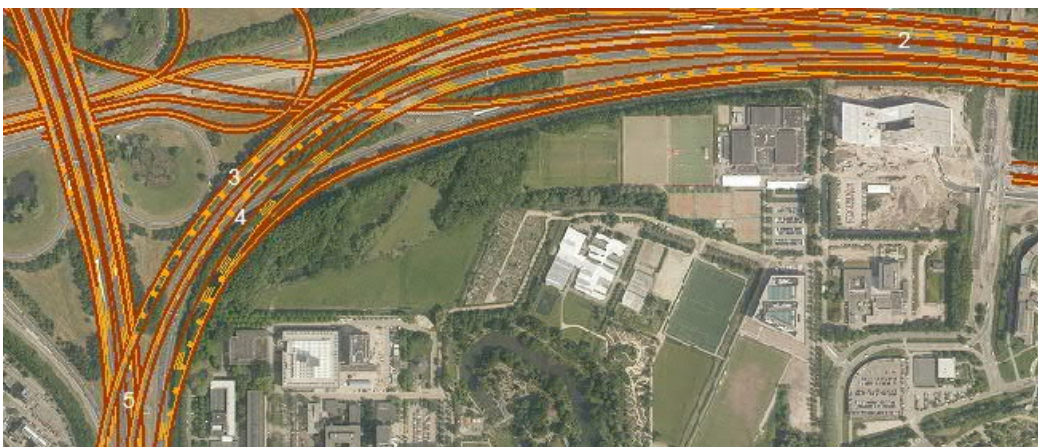
Figuur 3.6 De nieuwe verbindingsboog op niveau +2
