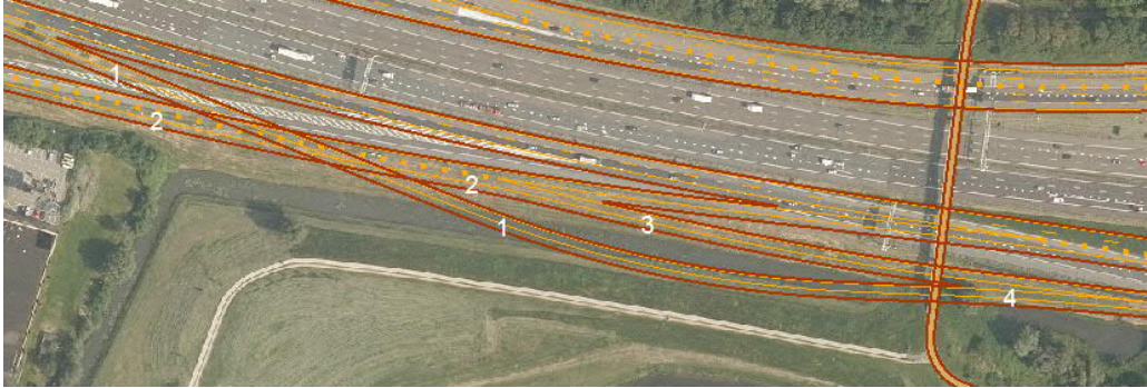
Figuur 5.2 Ongelijkvloerse kruising in de zuidbaan A12 tussen aansluiting Utrecht-Lunetten en Knooppunt Lunetten
